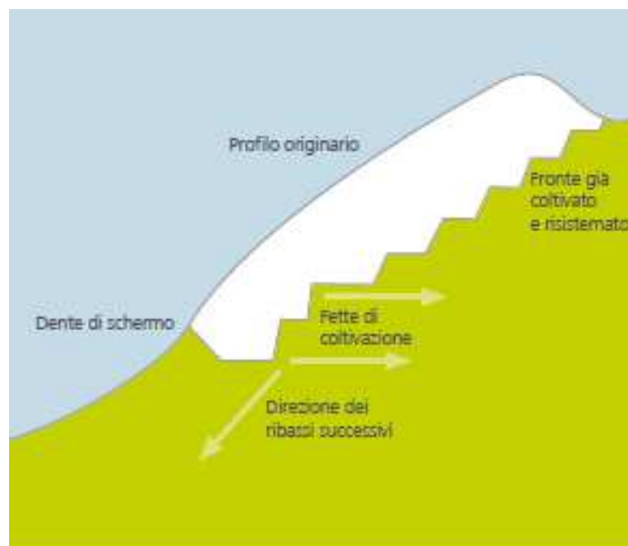
Figura 4.2 Coltivazione a gradoni per fette orizzontali discendenti su più livelli
