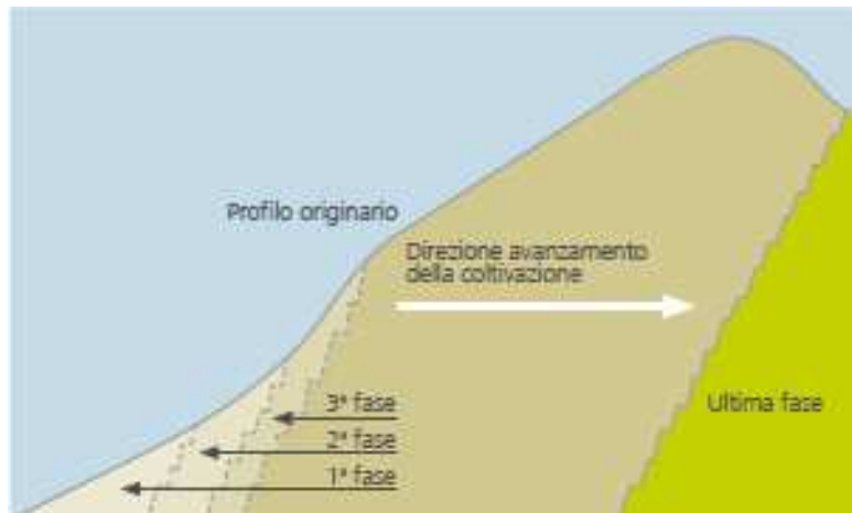
Figura 4.1 Coltivazione a gradoni per fette verticali montanti
